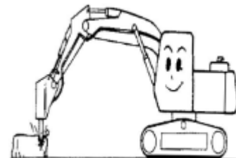
ATAQUE LA ROCA DESDE UN LADO Y POR SECCIONES CORTAS
